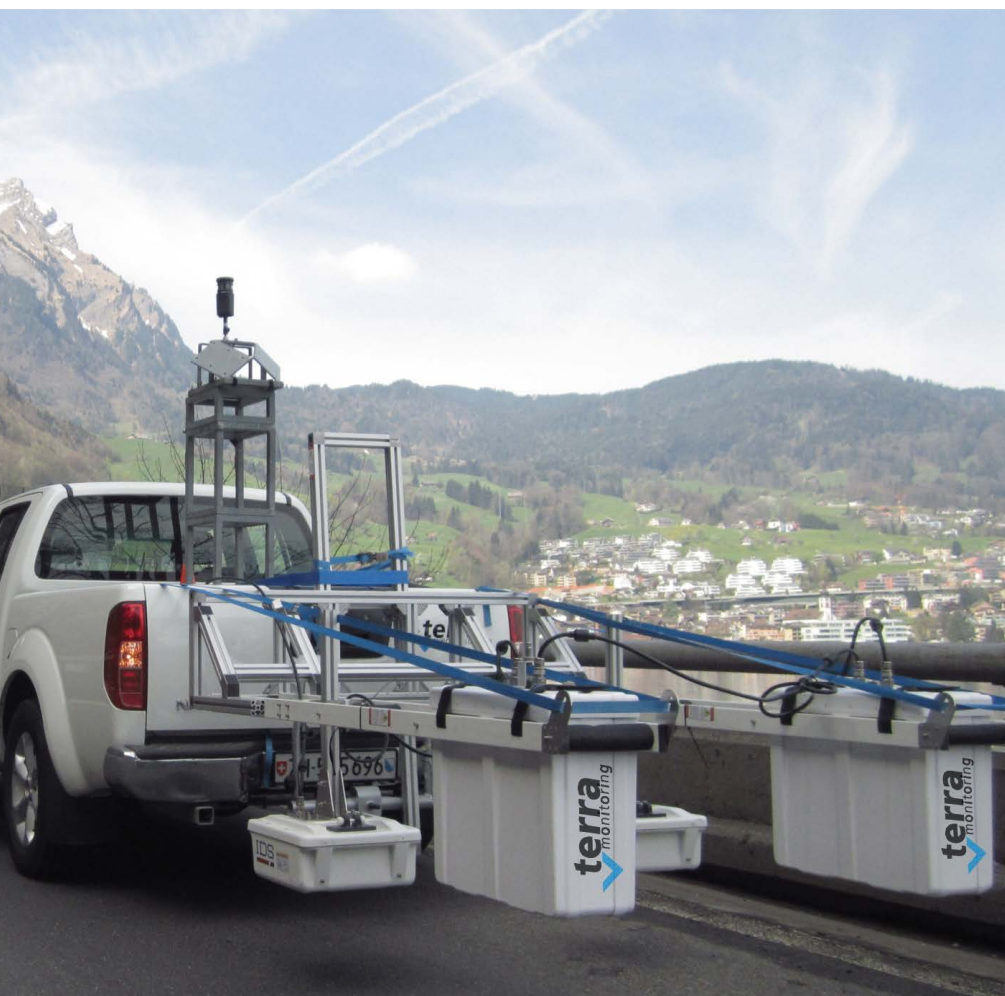
oberfläche mittels 3D-Laserscanning erfasst. Georadarmessungen erkunden den Strassenaufbau
